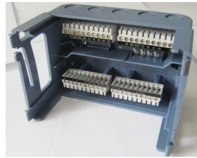
рис.1.Зовнішній вигляд клемної панелі
