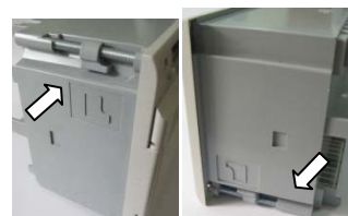
рис.5.Правильне положення та розміщення фіксаторів контролера
