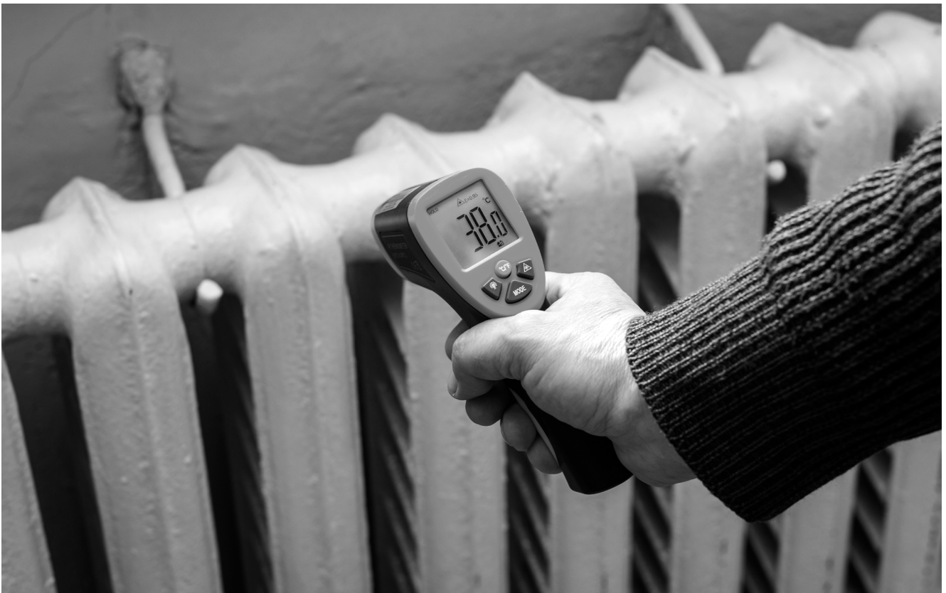
Фото 1: Енергоменеджер використовує пристрій для перевірки та демонстрації завгоспу параметрів роботи радіатор. Фото GIZ
