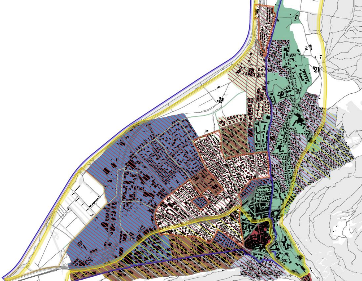
Рис. 4. План міста Кур із зазначенням зон, де має використовуватись скидне тепло сміттєспалювального заводу (темно-зелений), скидне тепло від станції очищення води (світло-зелений), підземні водні джерела (темно-синій), геотермальні джерела (світло-синій), деревина (коричневий), біогаз/природний газ (червоний), та зон, що придатні для використання сонячної енергії (жовтий).
